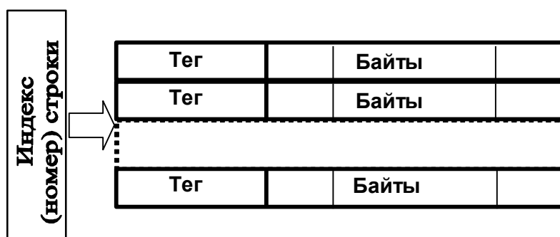
Рис. 4.17. Схема КЭШ памяти с прямым отображением.
