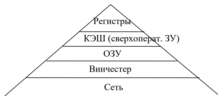
Рис. 1.9. Иерархическая структура памяти.
