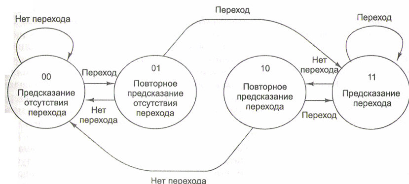
Рис. 1.12. Двухбитный конечный автомат для прогнозирования переходов.
